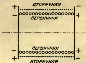
Рис. 5. Возникновение емкостного тока во вторичной обмотке.
